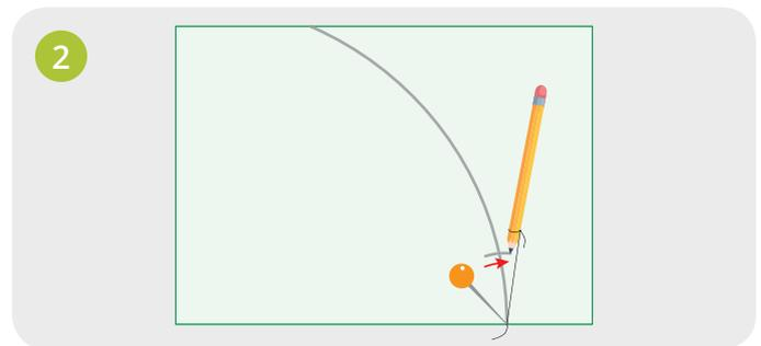
2 Binde den Bleistift nun bei 110 mm fest, stich mit der Nadel in die Stelle, wo der Bogen die untere Kartonkante kreuzt, und setze die erste Markierung für die Faltsegmente.
