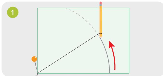
1 Miss 590 mm von der Schnur ab und binde den Bleistift an dieser Position fest. Fixiere das Schnurende mit der Nadel an der Spitze der Schultüte und zeichne mit dem Schnurzirkel einen Bogen.
