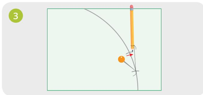
3 Versetze die Nadel auf die erste Markierung und zeichne nach diesem Prinzip alle fünf Segmente ein.
